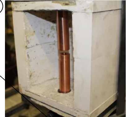
Elektroden- anordnung mit Box gemäß IEC 61482-1-2
